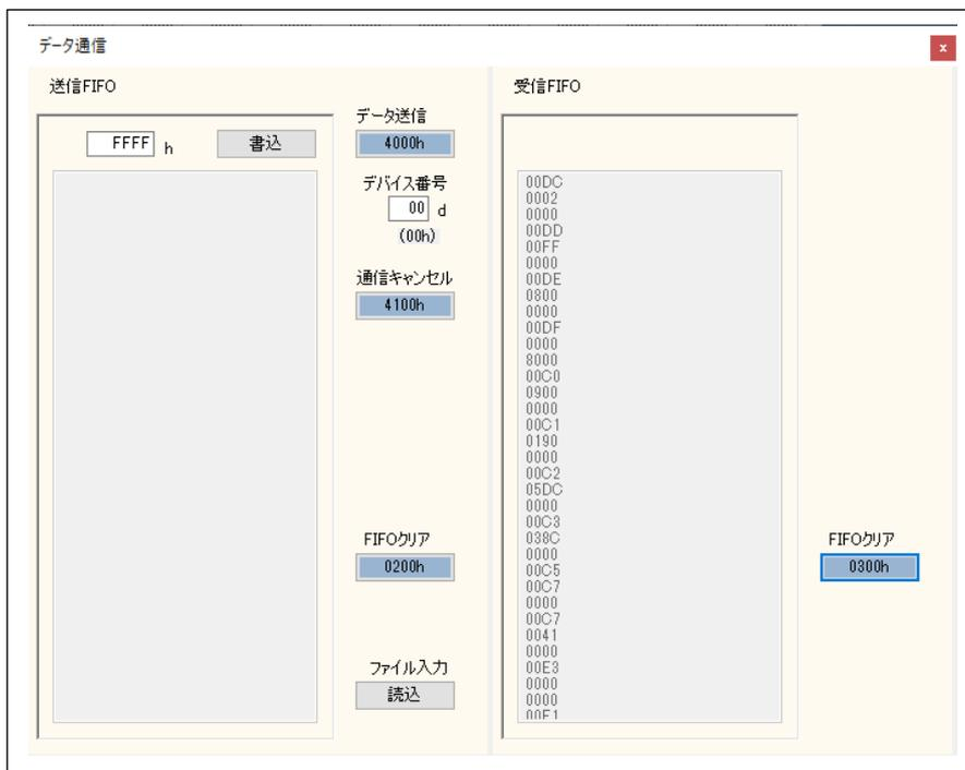
受信 FIFO の「読込」ボタンをクリックすることで、受信用 FIFO バッファに格納されたデータを読み出してデータ表示部にデータを表示します。受信用 FIFO バッファが空になったら「読込」ボタンを消去します。
