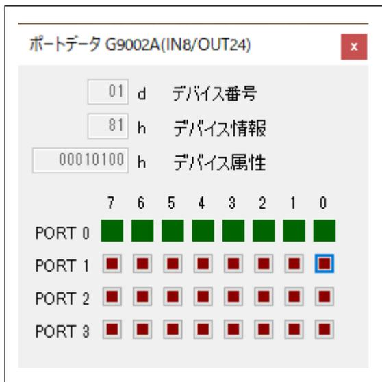
選択された「G9002A」のデバイス番号、デバイス情報、デバイス属性データを表示し、入力ポート PORT0 の 8 ビットの状態、及び出力ポート PORT1、PORT2、PORT3 出力状況を表示します。
