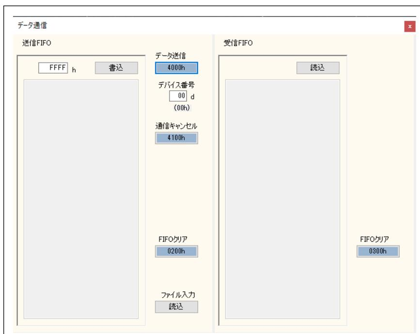
「4000h」ボタンをクリックして指定したデバイスに読出しコマンドを送信した時に、受信 FIFO に「読込」ボタンが表示されます。
